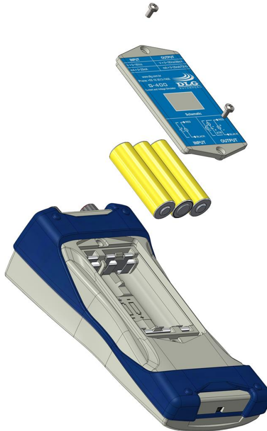
Figura 25 – Troca das baterias.
