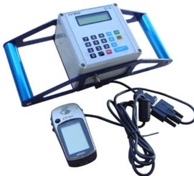
Figura 10 - Interligação do PNT ao GPS
