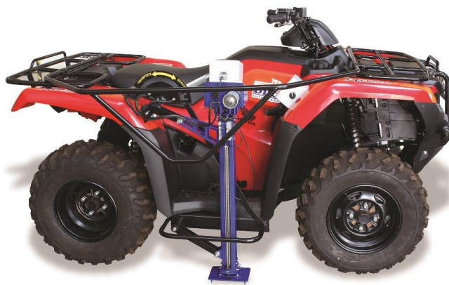
Foto 2: Alavanca travada na posição "Serviço"
