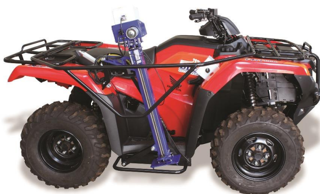
Foto 1: Alavanca travada na posição "Transporte"
