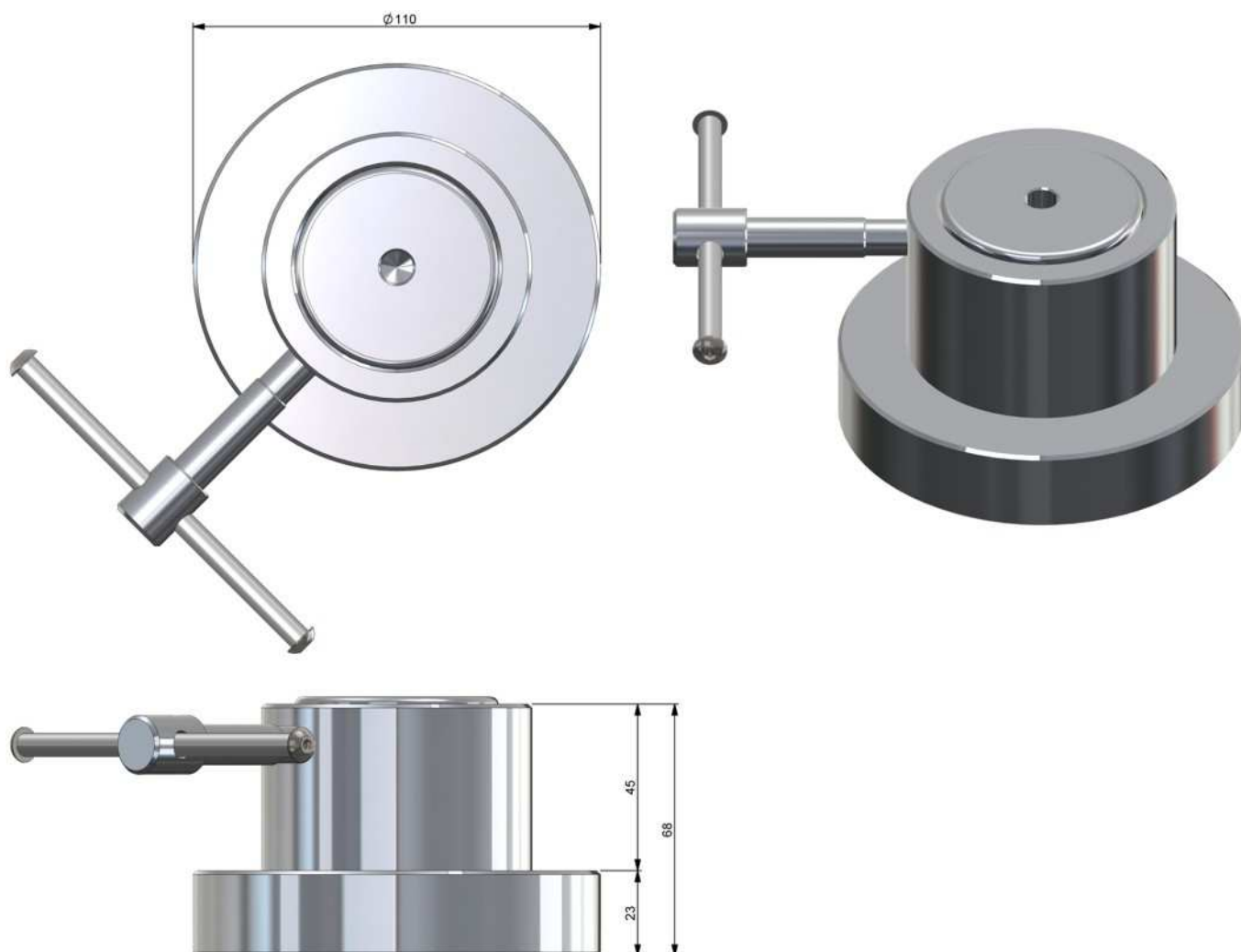
Figura 3 - Dimensionamento para montagem do Flange (Cotas em milímetro)
