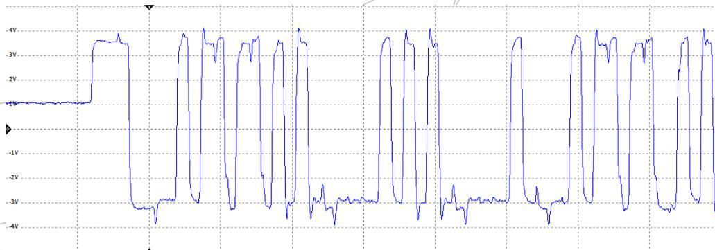
**Figura 10 Sinal diferencial antes do repetidor**
