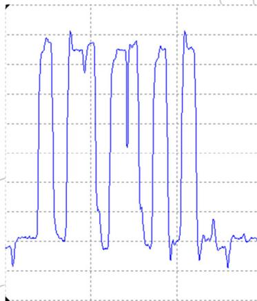
**Figura 7 Telegrama com ruído acoplado.**
