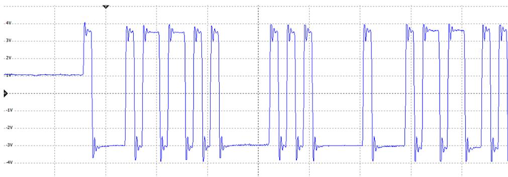
**Figura 11 Sinal diferencial depois do repetidor**
