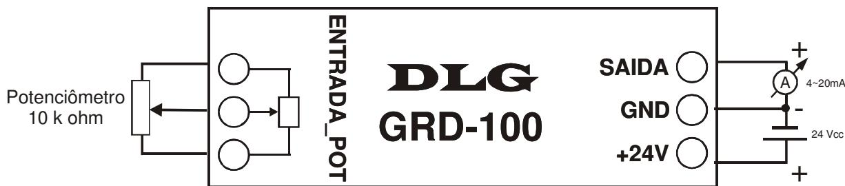
Figura 2 -Instalação com entrada de potenciômetro (modelo GRD-100/P)
