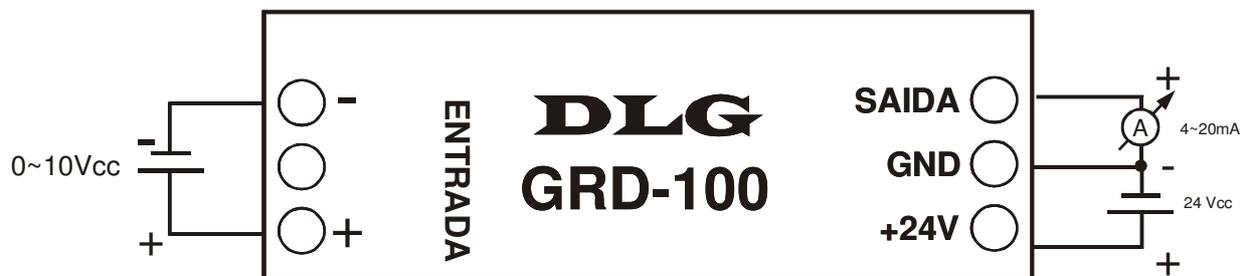
Figura 3 - Instalação com entrada de 0~10Vcc (modelo GRD-100/10)
