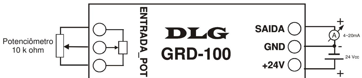
Figura 2 - Instalação com entrada de potenciômetro (modelo GRD-100/P)
