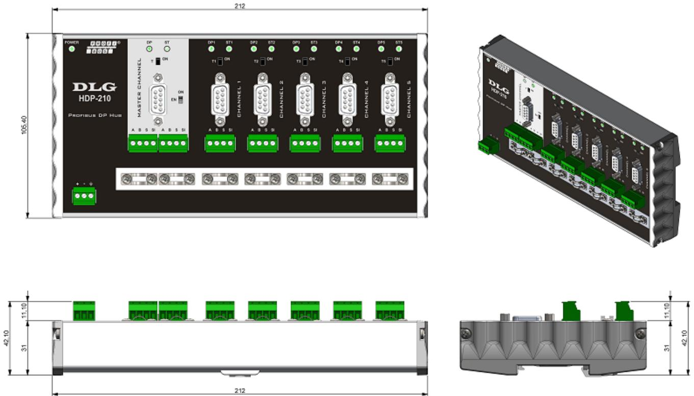
Figura 2 - Dimensionamento para montagem (cotas em milímetros)
