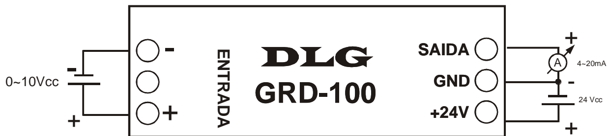
Figura 3 - Instalação com entrada de 0~10Vcc (modelo GRD-100/10)
