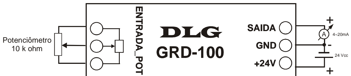
Figura 2 - Instalação com entrada de potenciômetro (modelo GRD-100/P)
