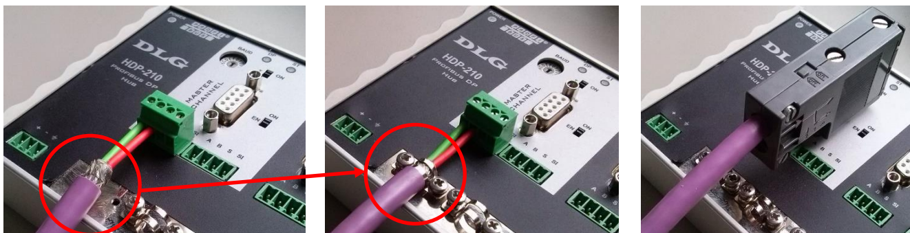
Ligar a malha do cabo na presilha
