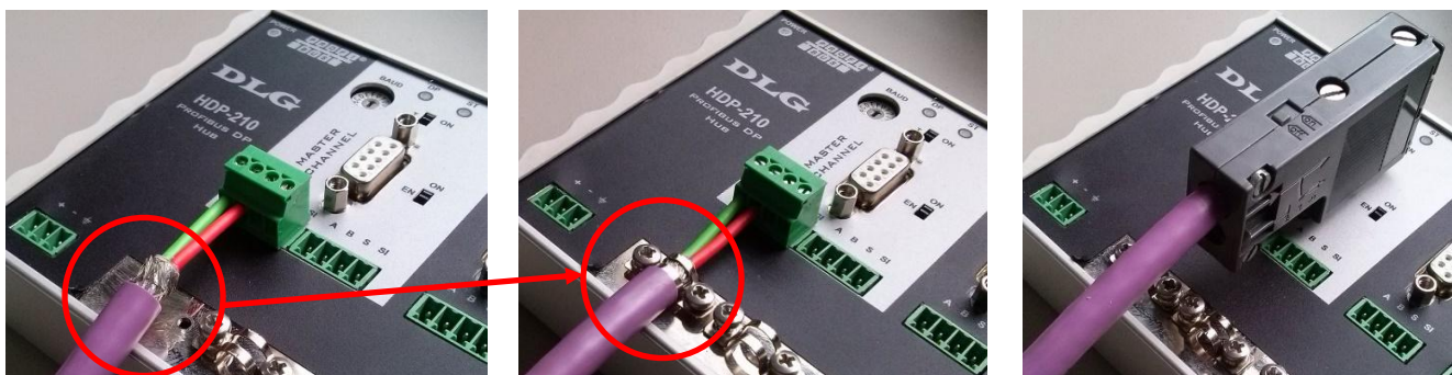
Ligar a malha do cabo na presilha
