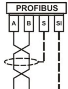
O conector DB9 e os bornes dos canais são conectados internamente, e podem ser utilizados em conjunto. Por exemplo, o HDP-210 pode ser conectado ao mestre Profibus pelos bornes com parafuso e um analisador de rede poderá ser conectado simultaneamente ao respectivo conector DB9, sem causar distúrbio à operação do equipamento.
