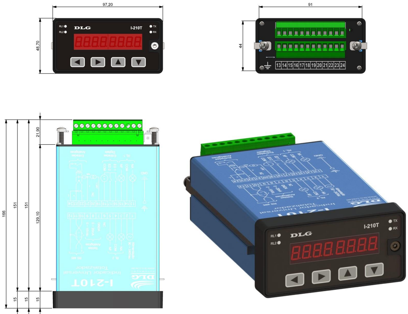
Figura 1 – Dimensionamento para montagem (cotas em milímetro)
