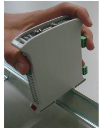
Utilizando uma chave de fenda, puxe a trava que se localiza na parte inferior do LMP-100. Após puxar a trava, fixe o LMP-100 na parte inferior do trilho DIN.
