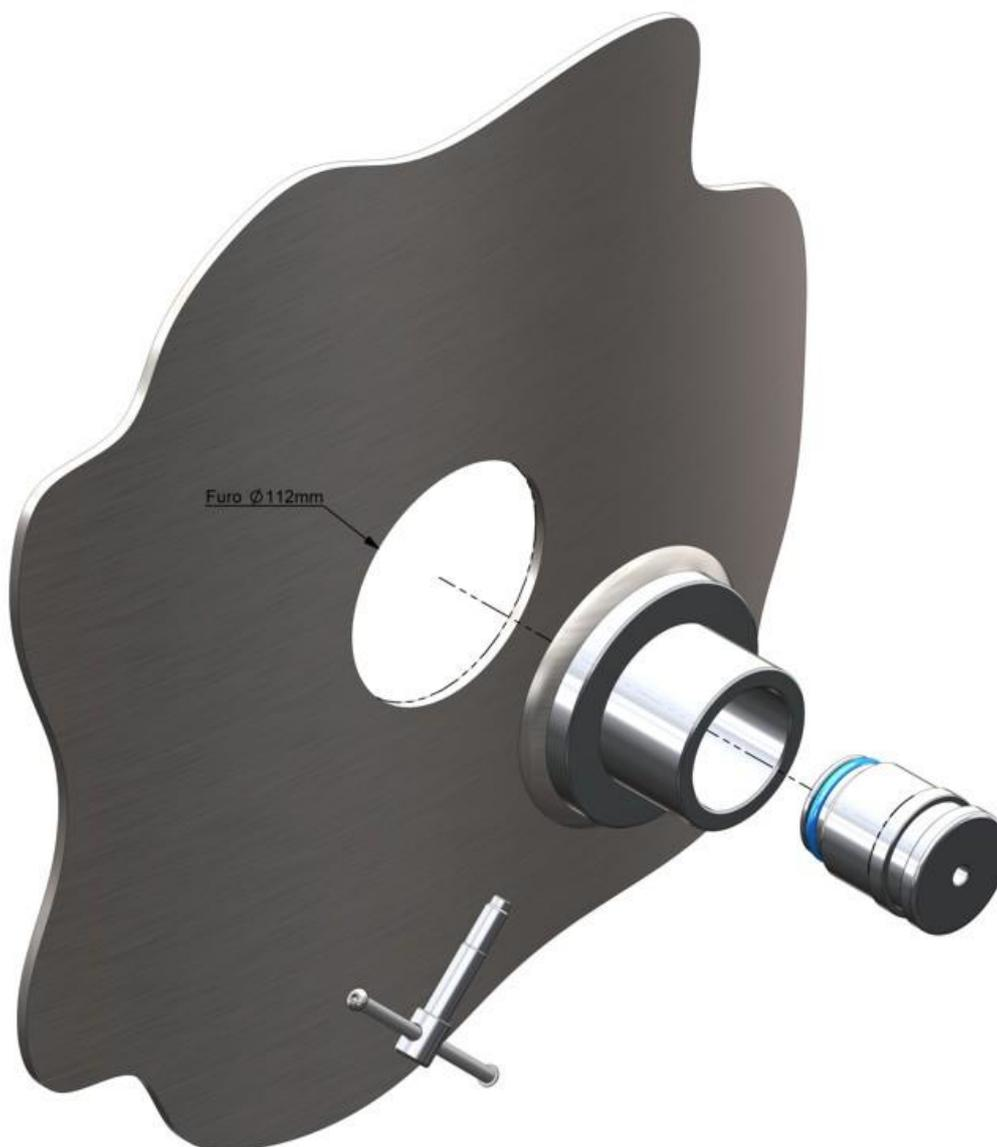
Após a soldagem da Flange deve-se aguardar o resfriamento das peças e somente após esta constatação realizar a montagem dos demais componentes da mesma.
