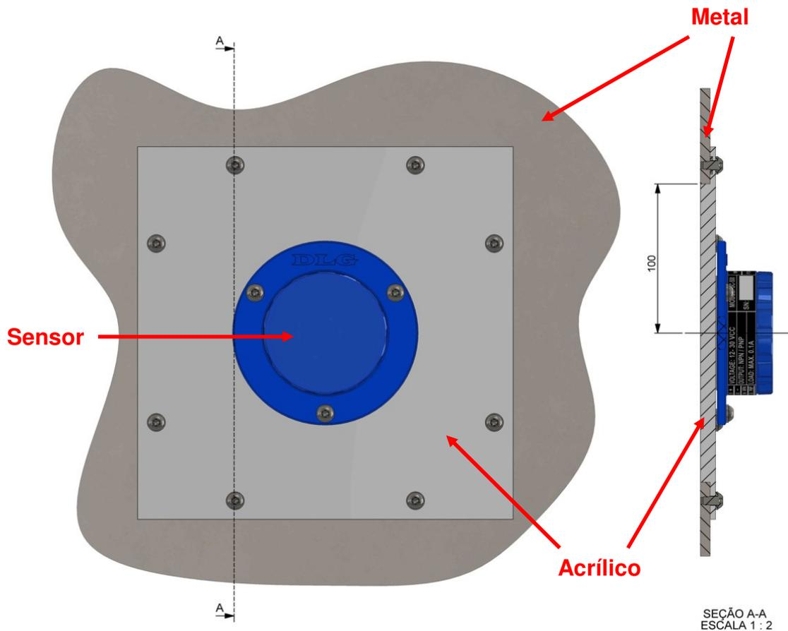
Figura 2 - Instalação do SC-500
