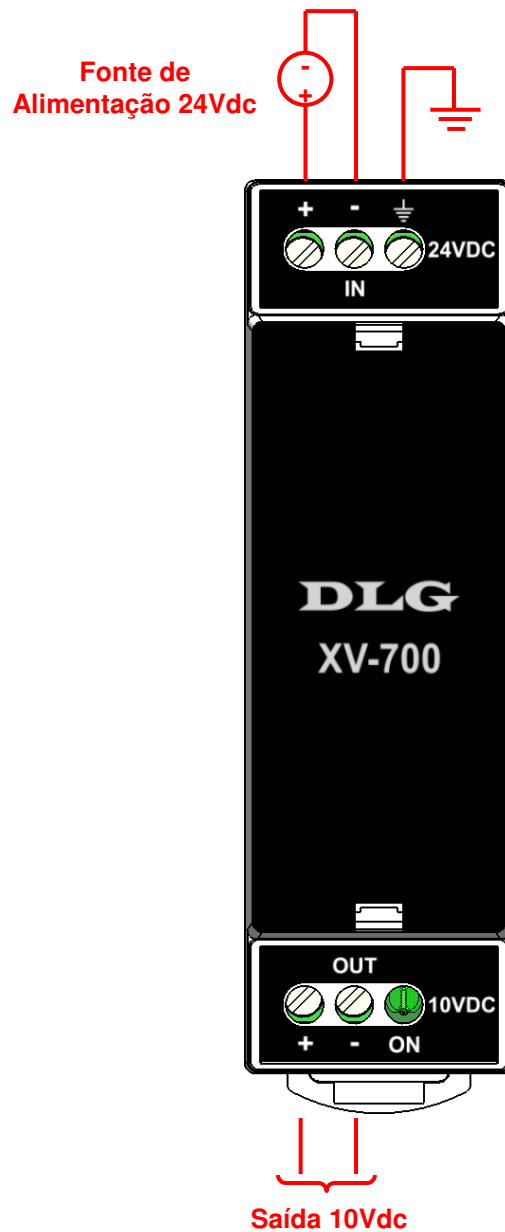
Figura 3 – Ligação Elétrica
