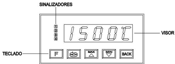
Figura 1 - Identificação das partes do painel frontal
