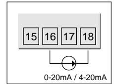
Figura 7 - conexão de corrente
