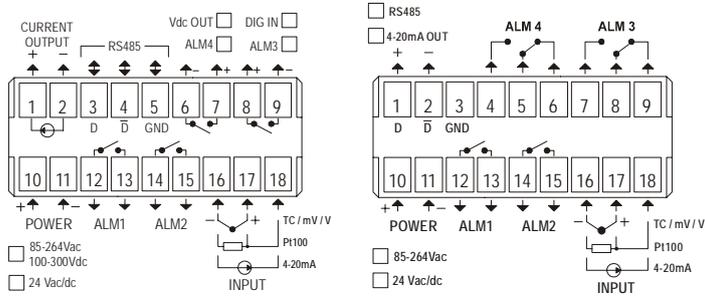
Figura 3 - Conexões do painel traseiro
