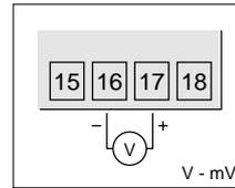
Figura 6 - conexão de tensão
