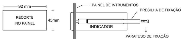
Figura 2 - Fixação do indicador ao painel de instrumentação
