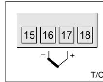
Figura 4 - conexão de termopar
