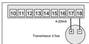
Figura 9 - Transmissor 2 fios com fonte 24Vcc
