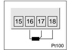
Figura 5 - conexão de Pt100 a 3 fios
