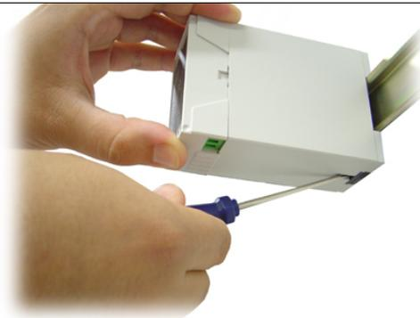
Após a chave de fenda ser colocada no encaixe, puxe a trava para cima de forma a fazer o pino de trava do conversor ir para baixo.
