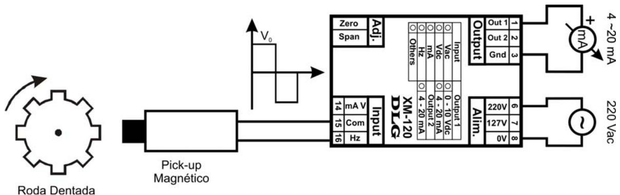
Figura 6 - Uso do XM-120/F com Pick-up magnético
