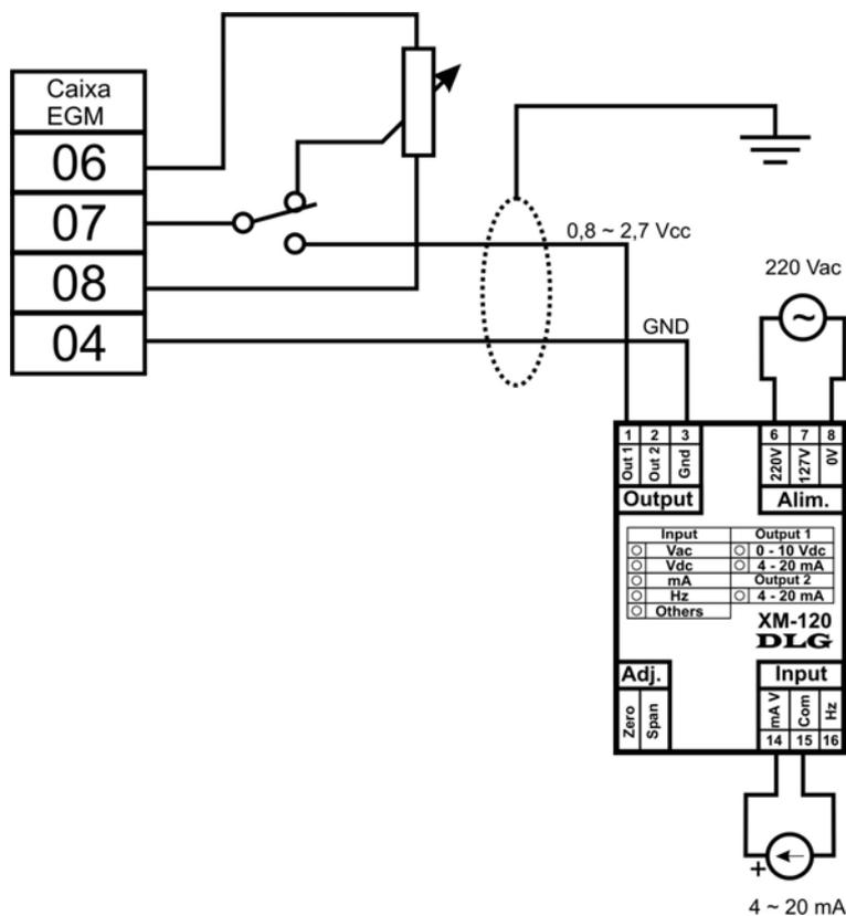
Figura 4 – Interligação com o Regulador Woodward
