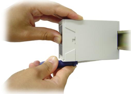
Empurre o conversor para traz até que este encoste na barra DIN. Solte o pino de trava e certifique-se que o modulo está devidamente preso e não há possibilidade de se soltar. Neste ponto o conversor está pronto para ser utilizado.
