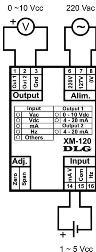
Figura 2 - Entrada 1~5Vdc , e Saída 0~10Vdc
