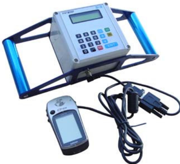
Figura 10 - Interligação do PNT ao GPS
